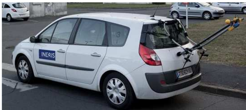
Figure 28 : dispositif d'enregistrement des mesures géoréférencées (support non métallique)
