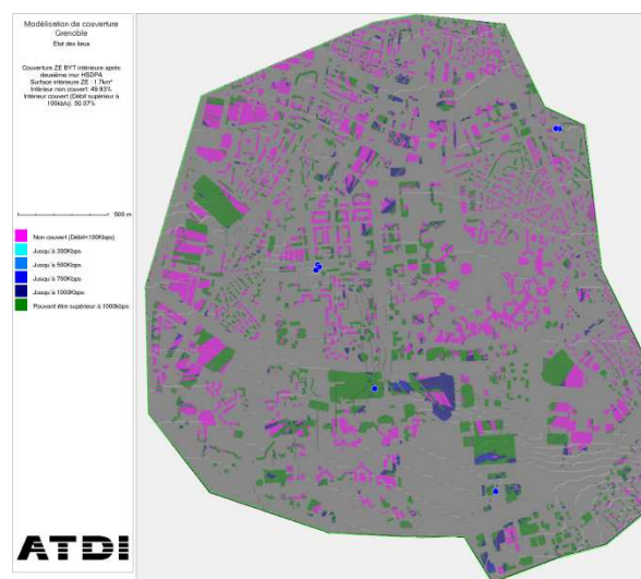
HSDPA intérieur après 2 ème mur
